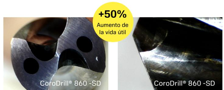
**Resultado:** CoroDrill® 860 con la geometría -SD superó a CoroDrill® R846 y el cliente logró aumentar la vida útil y reducir el coste por pieza a la vez que mantenía la seguridad del proceso y la integridad superficial.
