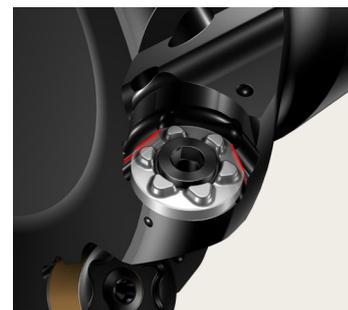
La correcta orientación de la placa de apoyo en la cavidad garantiza la precisión del montaje de la plaquita.
